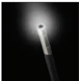
La sonda camera incorpora delle luci LED.
