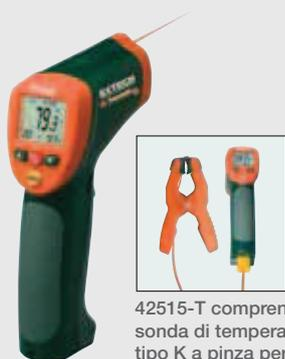
42515-T comprende sonda di temperatura tipo K a pinza per tubi
